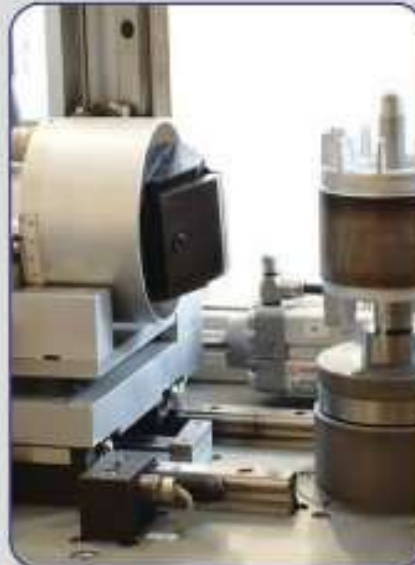
تجهیزات تست روتور RQA/125/Satas 2,RQA/300/ITS
